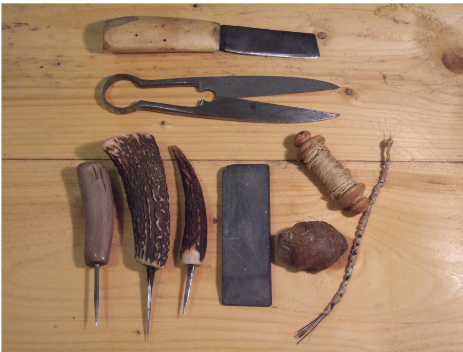
Figure 3 : différents outils de cordonnier : "un fagot" de soies de sanglier, un couteau de cordonnier, trois alènes forgées emmanchées sur des bois de cervidé, une bobine de fil de lin poissé, poix, forces et pierre à eau pour l'affûtage des outils (outils forgés par l'auteur).
