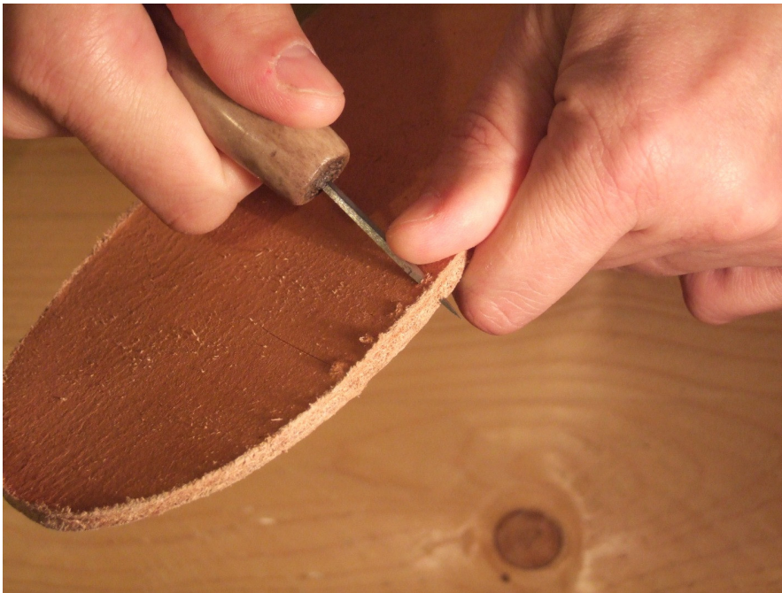
Figure 5 : utilisation d'une alène à section losangique (diamant) pour le perçage de la semelle, l'alène pénètre par le côté chair et ressort par la tranche de la semelle, ceci permettra une couture entièrement cachée à l'intérieur de la chaussure une fois celle-ci assemblée et retournée.
